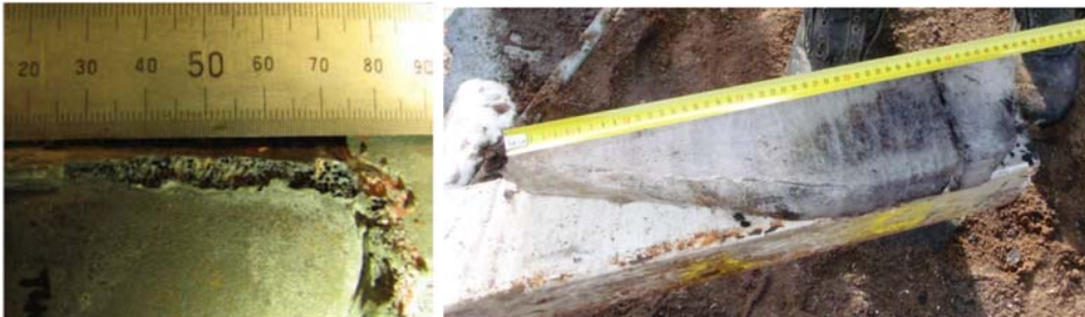
Kuva 3a ja 3b. Kriittisen liitoksen hitsin tunkeumaa päätylevyyn ja liittyvän putken sisällä ollut jää (kuvat: Y2013-1, OTKES).
